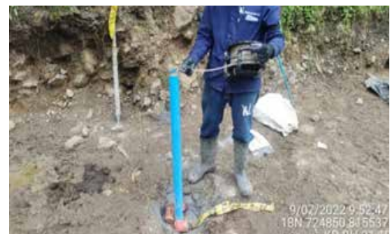
Utilización del piezómetro para el monitoreo de aguas subterráneas.
