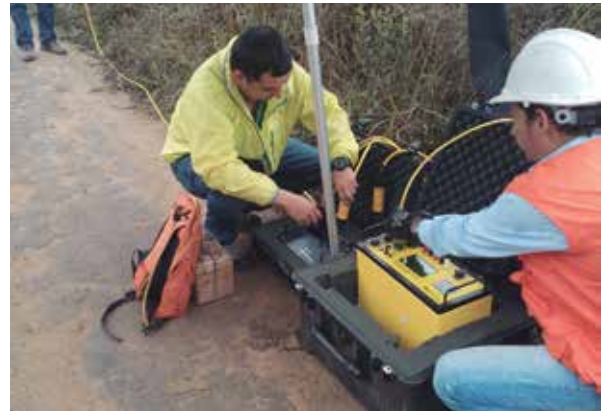
Realización de Tomografía 2D en el Municipio de los Santos.
