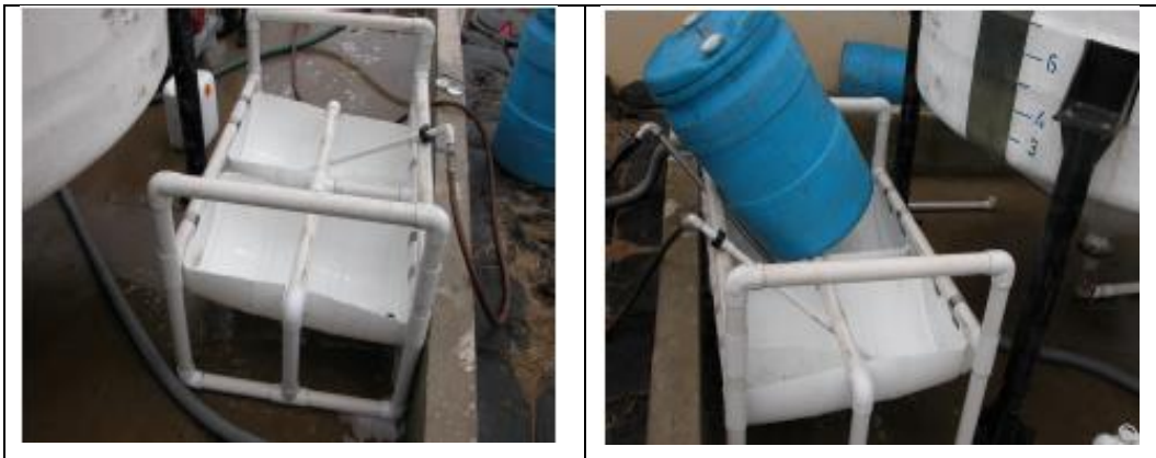
Fotografía 2.4-30 Dispositivo para lavado de envases de agroquímico
